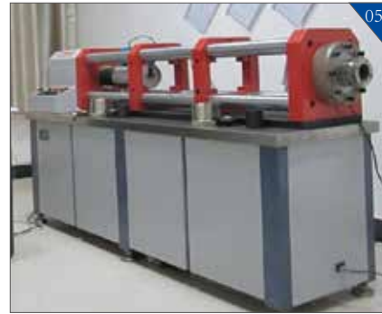
5-微机控制拉伸应力松弛试验机
