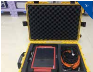
9-超声波成孔质量检测仪
