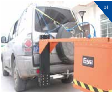
4-SIR-20型劳雷地质雷达+2.0GHz空气耦合天线
