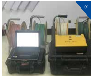
6-多通道声波透射法自动测桩仪
