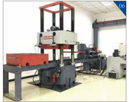
6-微机控制电液伺服压剪试验机
