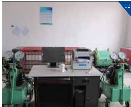
2-微机静载锚固试验机
