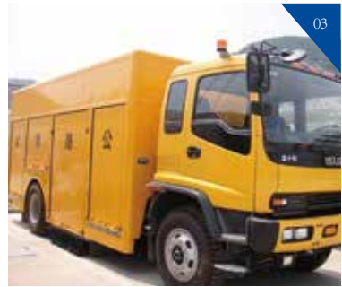
3-SFC-2007型路面横向力系数测试车
